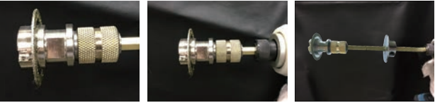
プラスビットに直接ワンタッチ。瞬時にビニールパイプを切断できる
