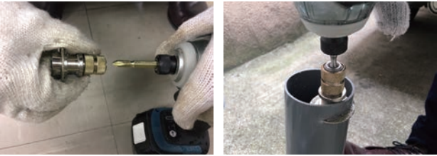
プラスビットに直接ワンタッチ。瞬時にビニールパイプを切断できる
